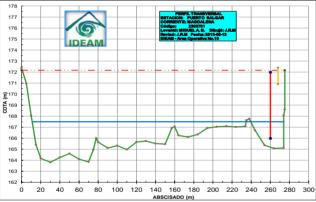
Sección transversal de la estación de Puerto Salgar, Río Magdalena. Nota: Es de anotar que los datos de nivel de las miras reportados diariamente por el IDEAM, NO corresponden a la profundidad total del río, sino al nivel del tramo inferior de la mira ubicada en la margen derecha del río, como se aprecia en la gráfica.
