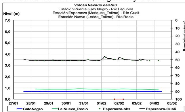
Debido a las precipitaciones registradas en la parte alta de la cuenca del río Saldaña se prevé ascenso moderado del nivel el día de hoy a la altura de la estación Piedras de Cobre, entre los municipios de Ortega y Saldaña (Tolima).
